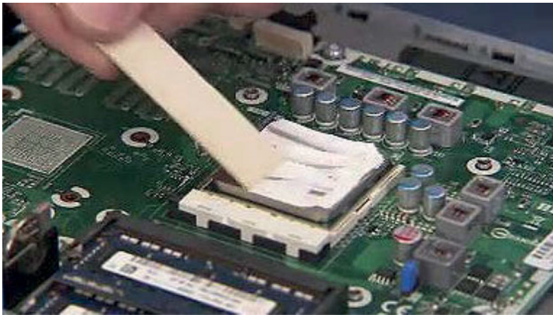
Εικόνα 2.7: Εφαρμογή θερμοαγώγιμης πάστας
