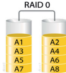
Εικόνα 3.1. Συστοιχία RAID 0 (striping).
