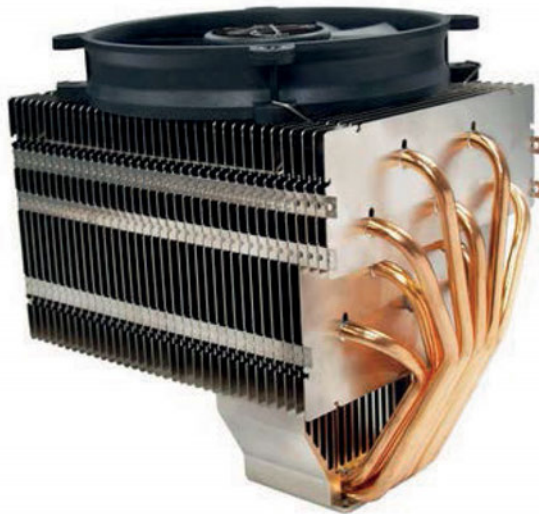
Εικόνα 2.9: Σύγχρονη ψύκτρα με θερμοαγωγούς
